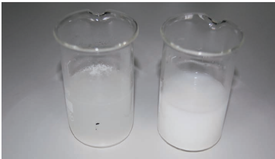
Abb. 1: Homogenisierung von Frischkäse. links = mechanischer Dispergierstab / rechts = Ultraschall
