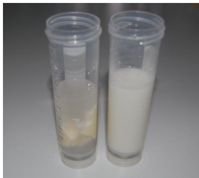
Abb. 1: Homogenisierung von Käse in Wasser mittels Ultraschallhomogenisator- vor und nach der Behandlung
